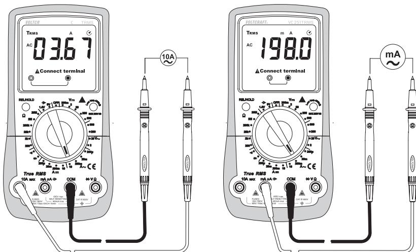
**请遵循以下步骤测量直流(A---)电流：**
